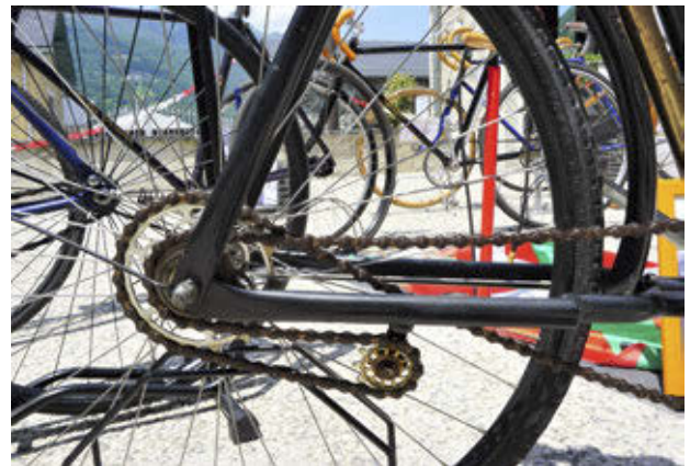
Une bicyclette Hironde (1903-1910), type route avec changement de vitesses rétro-direct.
